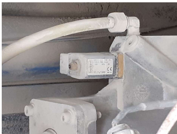
Pressostat de 16 bar du compresseur en location n°WCF301456
